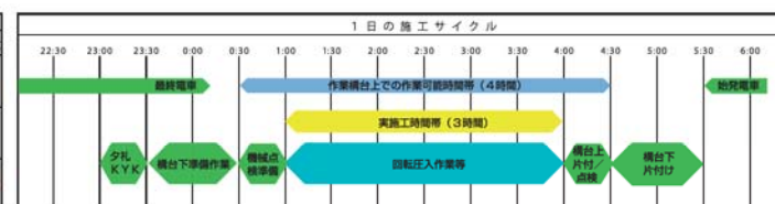
図-4 回転圧入杭施工サイクル
