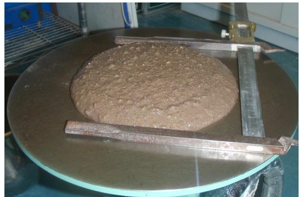
写真③ テーブルフロー測定状況
